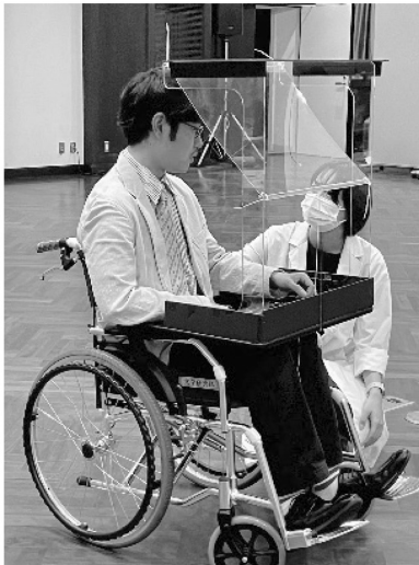
図2 車いすに装着した空中字幕装置（左）と台詞の空中表示例（右）
